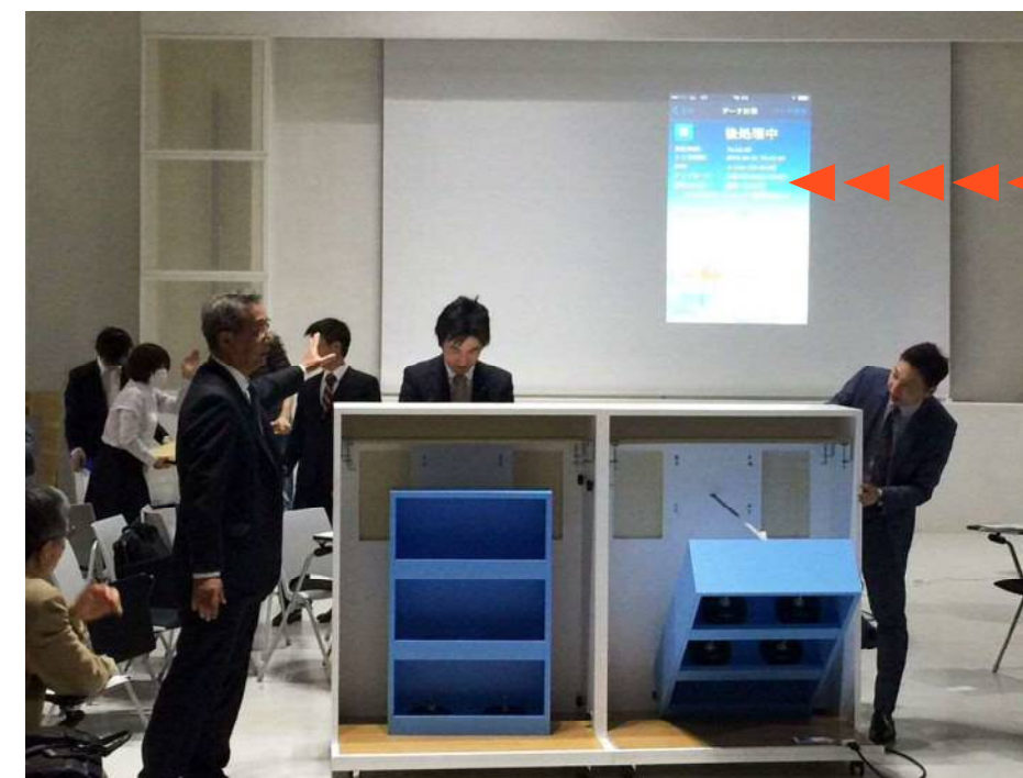
スマートフォンを本体に装着することで、震度計アプリケーションでリアルタイムに計測できます
